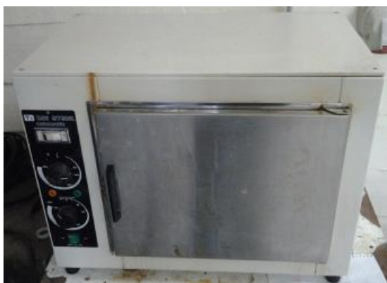
Ilustración 6.10. Estufa de secado, laboratorio de electroquímica LOU. Fuente: propia
