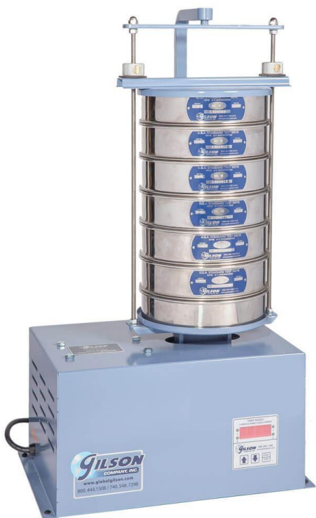
Ilustración 6.9. Tamizador y tamices GILSON CO®. Fuente: propia
