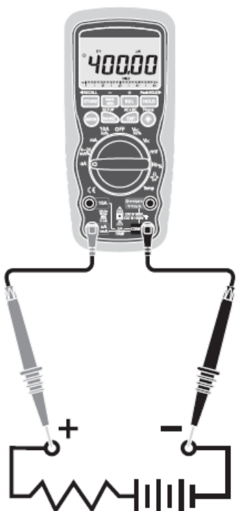
Figura 6.6. Esquema de medición del multímetro. Fuente: propia, a partir de manual de equipo
