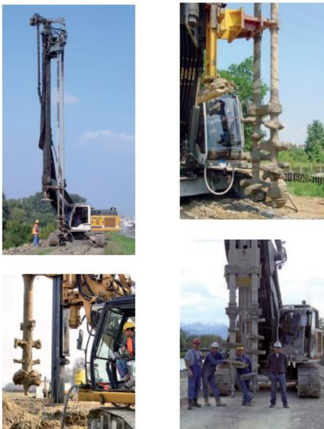
Figura 2.6. Maquinaria Típica utilizada en el método DSM húmedo. (Fuente: Ref. [26]).
