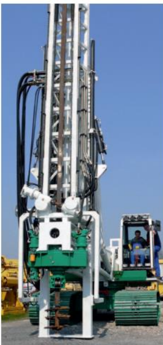
Figura 2.9. Eje Keller para Dry Soil Mixing. (Fuente: Ref. [26]).
