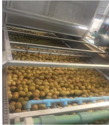
Fuente: Cefrupal Figura 1-10 Lavadora y cepilladora
