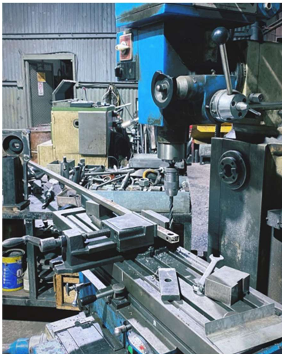
Figura 2.10 Fresadora universal "Profila" Fuente M&N Mining
