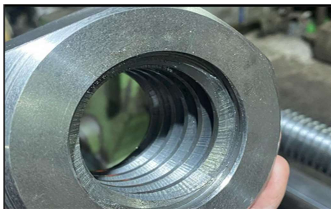
Figura 2.9 Trabajos terminados en Torno “tuerca de torno” Fuente M&N Mining
