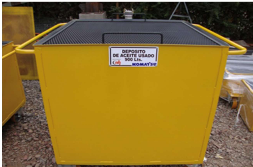
Figura 3.32 Modelos de depósitos de aceite usado. Fuente M&N Mining
