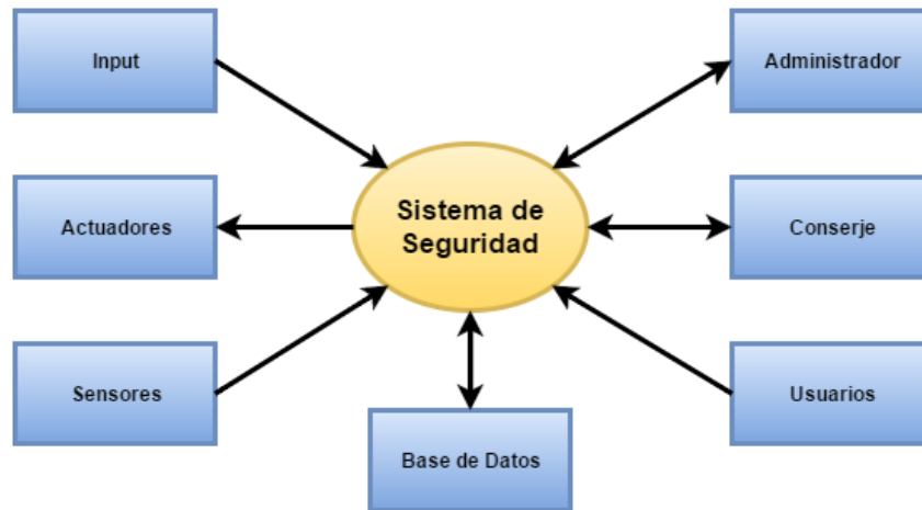
Ilustración 5: Diagrama de Contexto del sistema de seguridad
