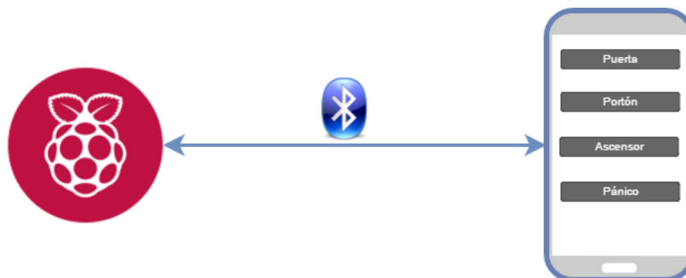
Ilustración 24: Diagrama de interacción entre Raspberry y aplicación usuarios.
