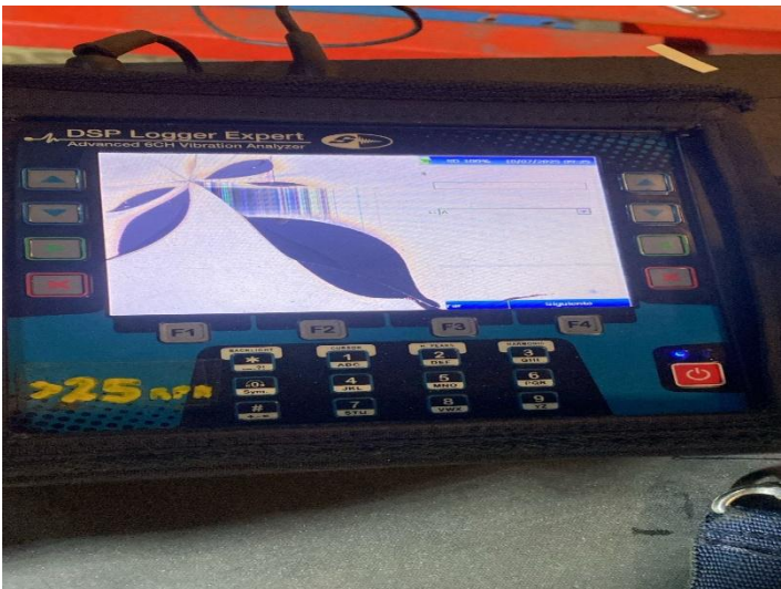
Figura 2. 5: Equipo de vibraciones fuera de servicio.
