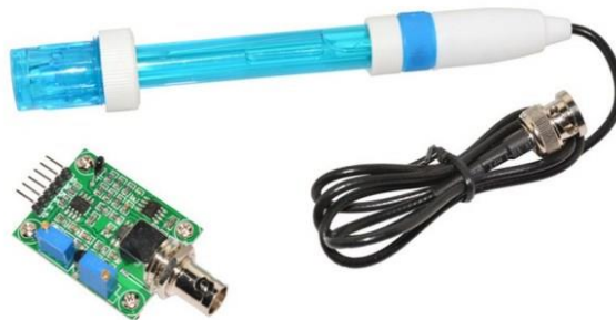
Figura 1-10. Sensor de pH con sonda.
