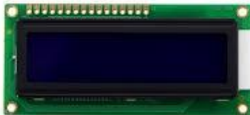
Figura 1-12. Pantalla LCD Display 16x2 Azul.
