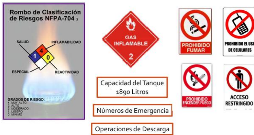
Figura 21: Rotulación típica en instalaciones de GLP
