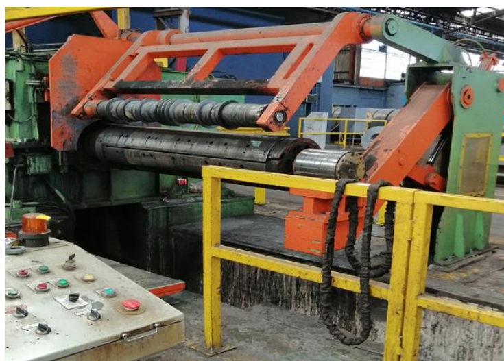
Imagen 9: Equipos que no cuentan con las debidas protecciones. Slitter (izq.) y tambor enrollador (der.). Fuente: Elaboración propia.
