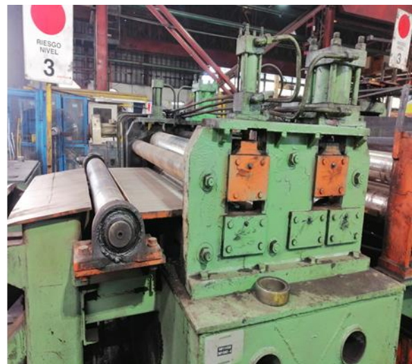
Imagen 11: Guillotina (izq.) cumple con las protecciones, mientras que el enhebrador de punta de bobina (der.) no tiene las protecciones requeridas. Fuente: Elaboración propia.
