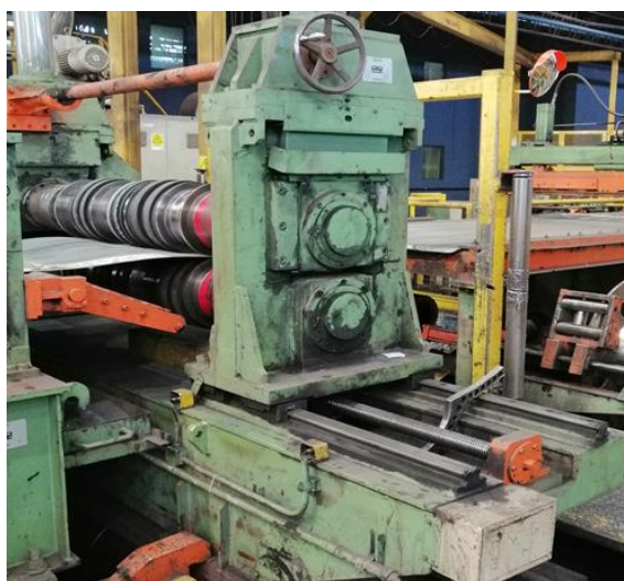
Imagen 9: Equipos que no cuentan con las debidas protecciones. Slitter (izq.) y tambor enrollador (der.). Fuente: Elaboración propia.
