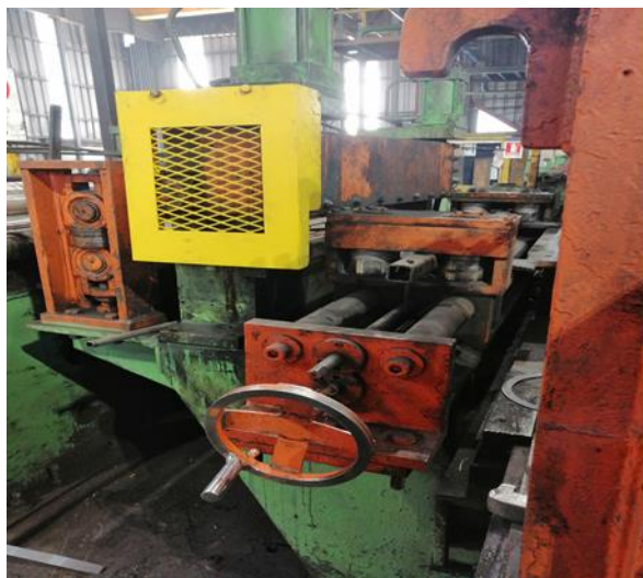
Imagen 11: Guillotina (izq.) cumple con las protecciones, mientras que el enhebrador de punta de bobina (der.) no tiene las protecciones requeridas. Fuente: Elaboración propia.
