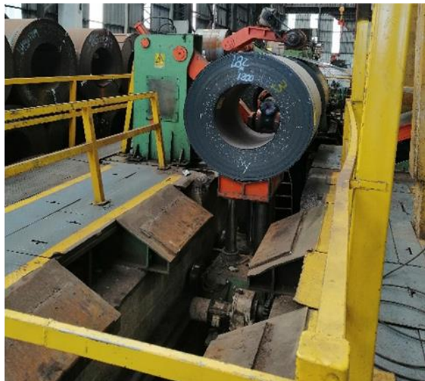
Imagen 8: Equipos que cuentan con las debidas protecciones. Soporte para bobina (izq.) y carro para bobina (der.). Fuente: Elaboración propia.
