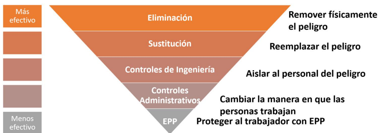
Imagen 4: Jerarquía de controles de riesgo. Fuente: Sepresst.
