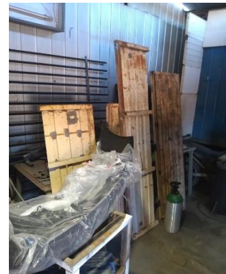
Imagen 3: Compilado de situaciones frecuentes en el sector de soldadura, despuntes y perfiles largos acumulados, trabajos terminados y elementos innecesarios, elementos en proceso pobremente ubicados.
