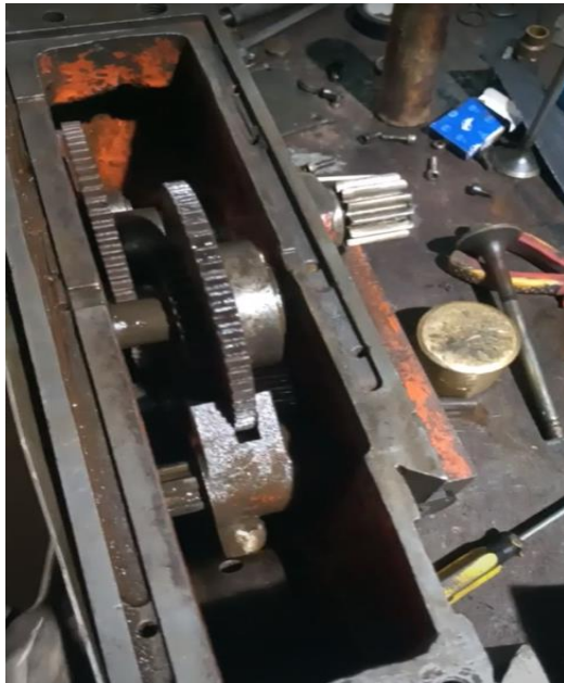
Respaldo visual N°61: Carro principal reensamblado y reinstalado en el torno.
