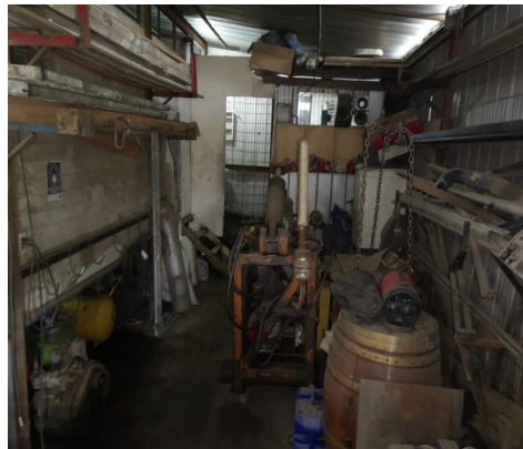
Imagen 3: Compilado de situaciones frecuentes en el sector de soldadura, despuntes y perfiles largos acumulados, trabajos terminados y elementos innecesarios, elementos en proceso pobremente ubicados.
