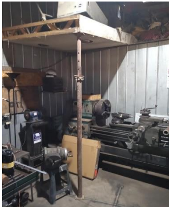
Imagen 2: Condiciones inseguras presentes en el sector de mecanizado, pilar inestable, conexión a la corriente eléctrica en mal estado, y pobre iluminación.
