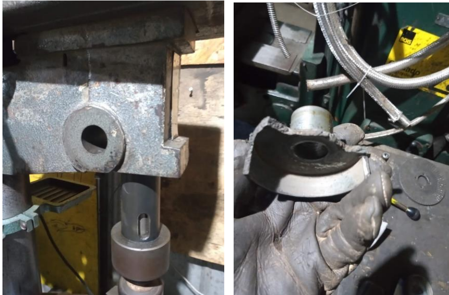
Respaldo visual N°56: Extracción de la pieza en mal estado y detalle de la falla.
