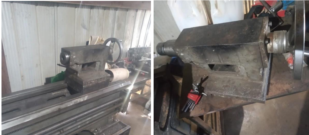
Respaldo visual N°58: Desmontado de la contrapunta del Torno 2 para su desensamble.
