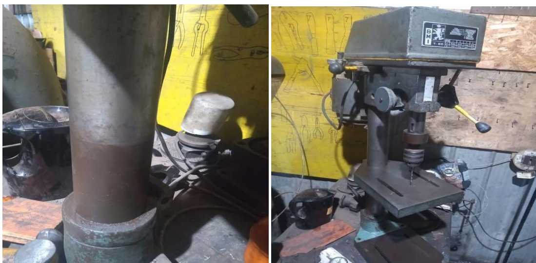
Respaldo visual N°55: Pilar del taladro, con la zona superior pulida y resultados de la limpieza total.
