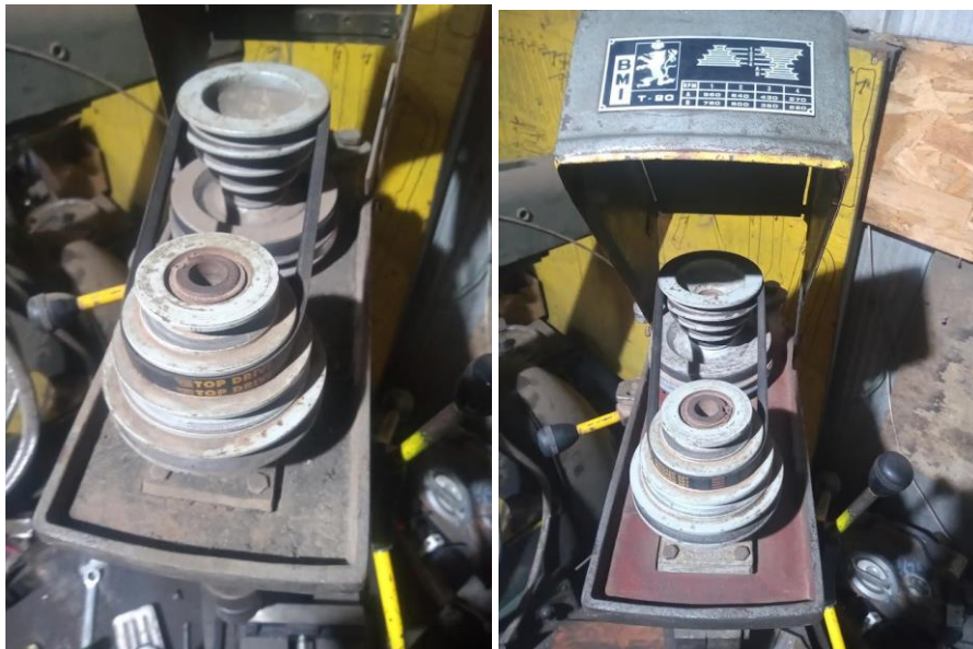
Respaldo visual N°54: Limpieza parte superior de taladro, antes y después.
