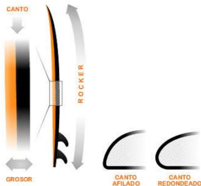
Figura 1-3. Grosor, rocker y canto
