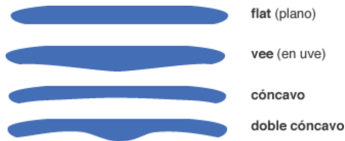
Figura 1-5. Tipos de fondo de una tabla de surf
