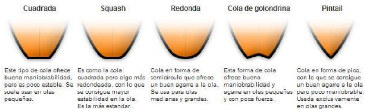
Figura 1-4. Tipos de colas de una tabla de surf
