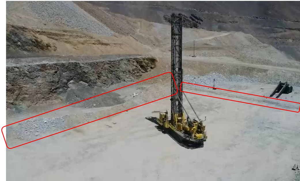
Figura 15. Ejemplo de diseño berma de seguridad
