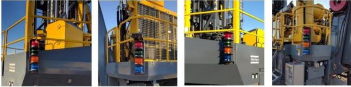
Figura 7. Semáforos de luz en perforadora autónoma.
