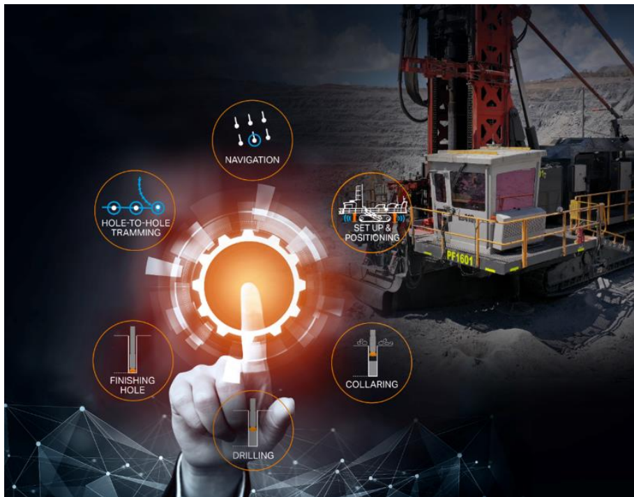
Figura 13. Ciclo de perforadora autónoma
