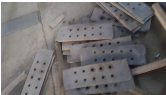
Figura 2-2 Placas utilizadas para plantillaje.
