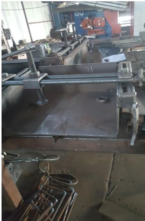
Figura 2-1 Prensa especial para realizar plantillaje.
