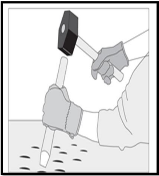
Figura 2-22. Preparación De Piso.
