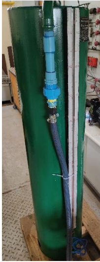
Figura N°14: Estanque receptor de agua.
