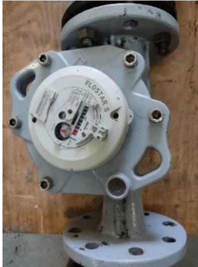
Figura N°26: Medidor general retirado.
