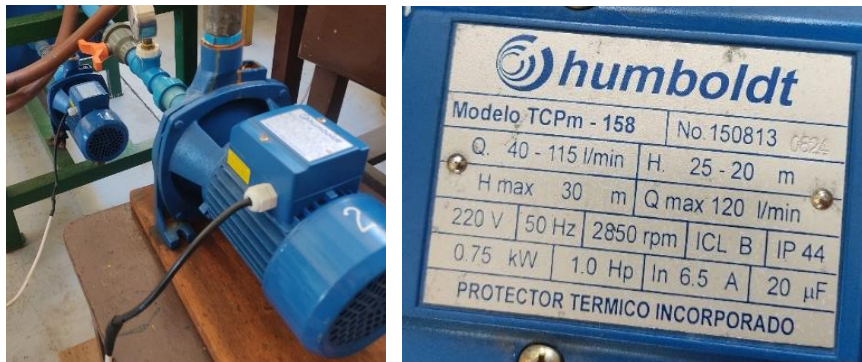
Figura N°11: Bomba centrífuga y características técnicas principales.
