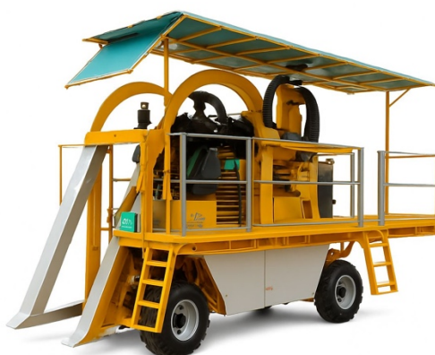
Figura 3-13. Cosechadora OXBO 9140 · Frambuesas.
