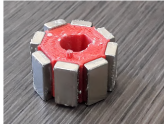
Figura 4.2: Traslador A Impreso y con Imanes
