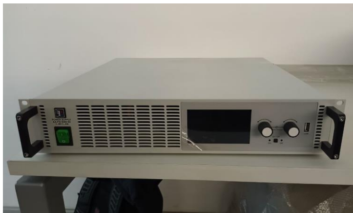
Figura 31: Fuente de poder Elektro-Automatik EA PSI 9080-40 utilizada en prueba de electroluminiscencia. Fuente: Elaboración propia.
