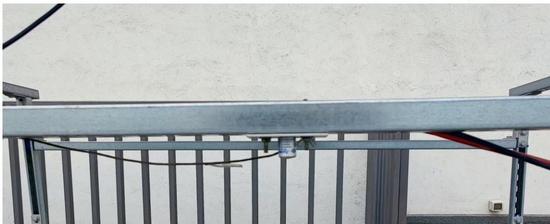
Figura 23: Piranómetro ML-01 para medición de albedo montado en módulo B_1 . Fuente: Elaboración propia.
