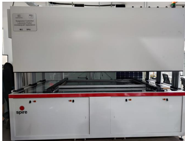
Figura 28: Simulador de pulso solar marca Eternalsun Spire con módulo monofacial en su interior. Fuente: Elaboración propia.
