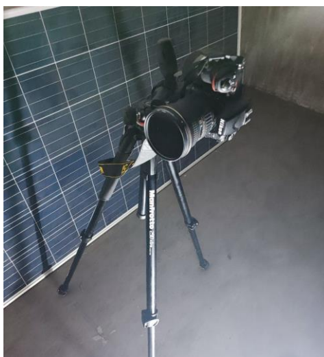
Figura 30: Cámara Nikon D750 con filtro infrarrojo montada en el trípode en el laboratorio de electroluminiscencia. Fuente: Elaboración propia.
