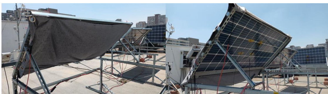
Figura 35: Medición de cara frontal de módulo B_1 con cortina “blackout” cubriendo cara posterior (izquierda) y medición de cara posterior con cortina “blackout” cubriendo cara frontal (derecha). Fuente: Elaboración propia.
