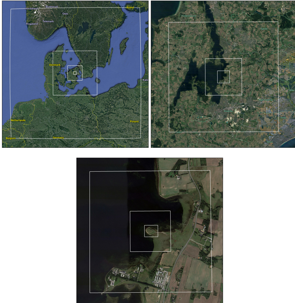
Figura 5.6: Distribución telescópica de las 8 mallas anidadas en el dominio numérico de la colina Bolund.
