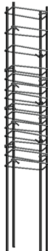
Figura 51: Armadura probetas RM5 y RM6.
