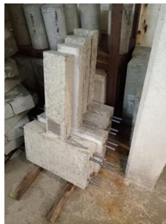
Figura 179: Curado de Hormigón en sala Húmeda LEMCO.
