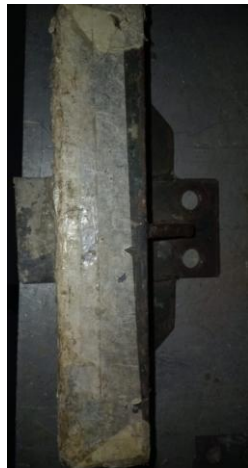
Figura 183: Zapato de apoyo probeta-mesa sísmica.
