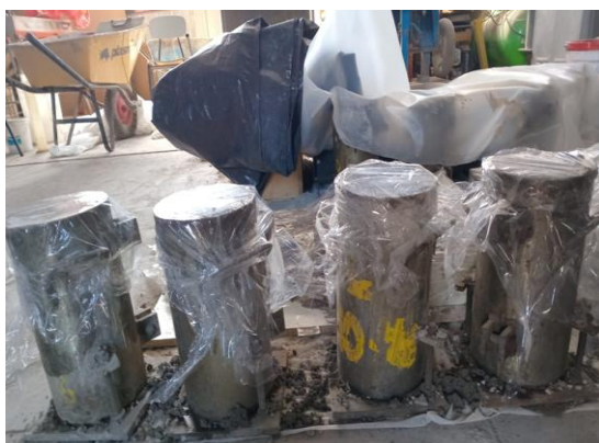
Figura 178: Hormigonado de cilindros.
