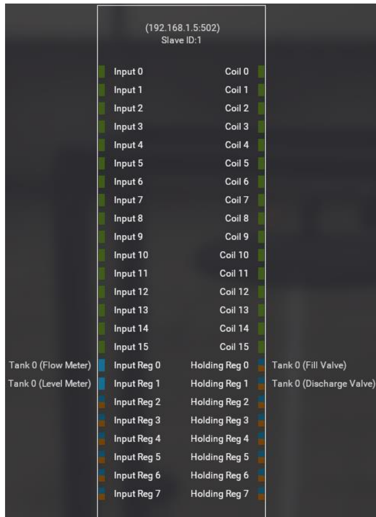
Figura 2-3. Asignación de variables del proceso a registros Modbus en Factory I/O.
