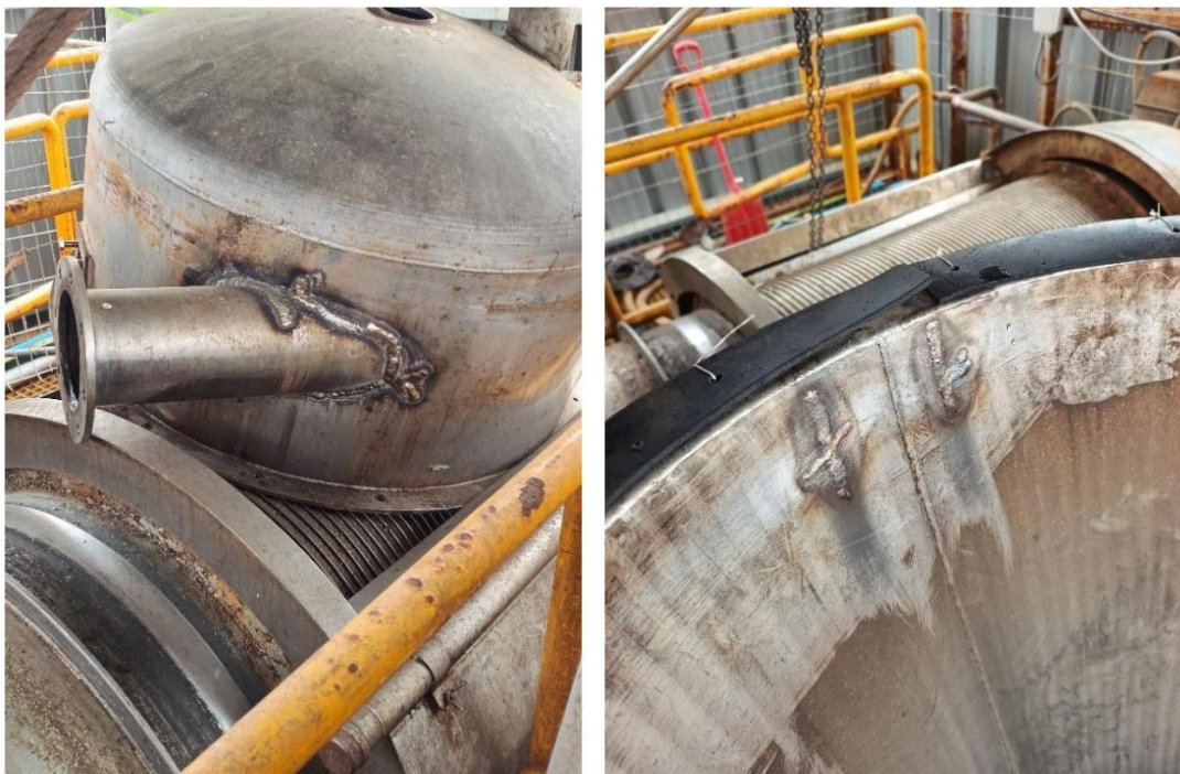
Figura 2-11 Daños del surtidor
