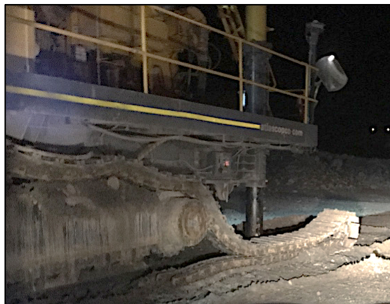
Figura 40. Oruga descarrilada por pasador cortado en perforadora PV351 [Fuente: Elaboración Propia]
