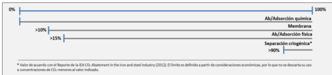
Figura 2-3. Rangos de concentración de CO 2 en corrientes de emisiones, según tecnología de separación (Fuente: [1], p.20)
