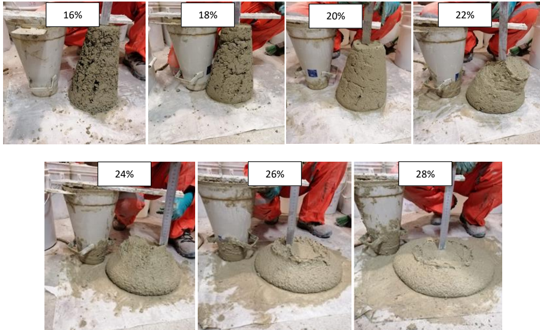
Fig. 9.6-13: Fotografías del ensayo 5, muestra de material A (café) del "Cono de Abrams".
