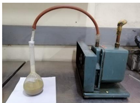
Fig. 4.5-5: Fotografía de un procedimiento del método por picnómetro. Picnómetro con muestra conectado a la bomba de vacío para quitar el aire atrapado.
