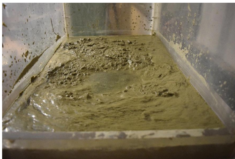
Fig. 5.5-10: Imagen de la vista superior interior del modelo físico con una subsidencia atestada de agua. Para este experimento se presentó un evento violento de agua-barro (posterior a una colgadura), el cual tuvo un alto desplazamiento lineal sin embargo no fue tan veloz.
