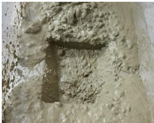
Fig. 5.7-13: Imagen de la vista superior interior del modelo físico con la muestra trabajada para el experimento 3, después que fluyera el material.
