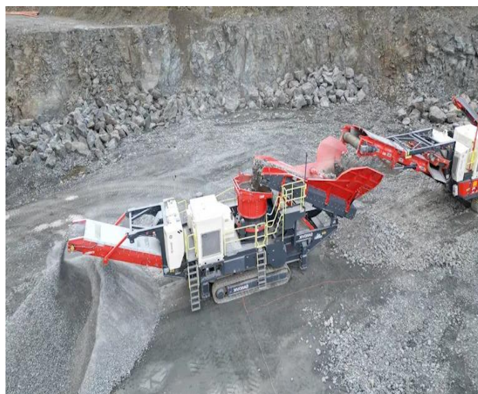
Figura 2-6: Las cintas transportadoras depositan el material en el chancador.
