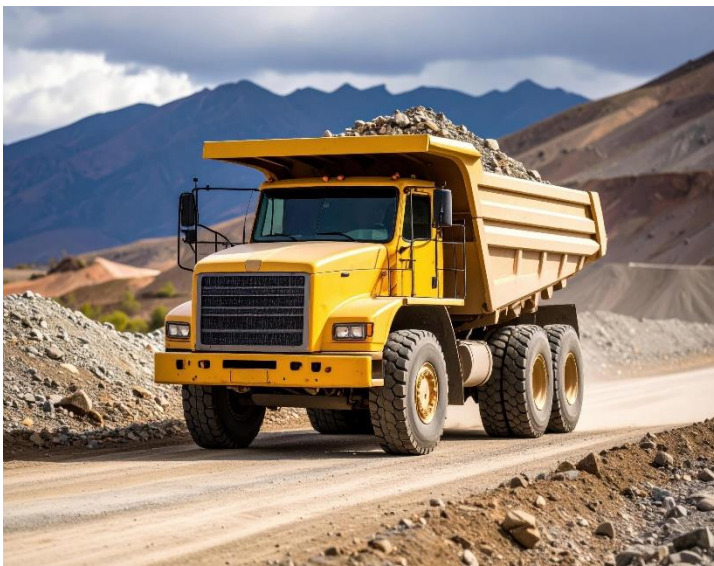
Figura 2-4: Camión tolva transportando material a la planta de áridos.
