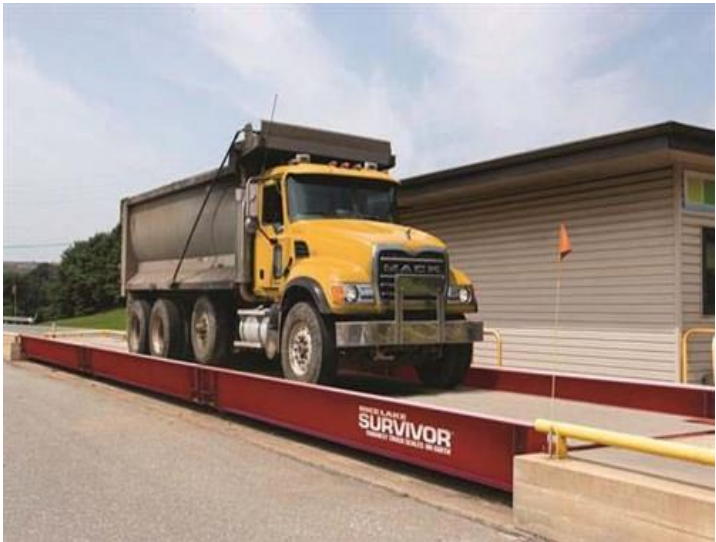
Figura 2-10 Pesaje de camión con los áridos en la báscula y pronto despacho.
