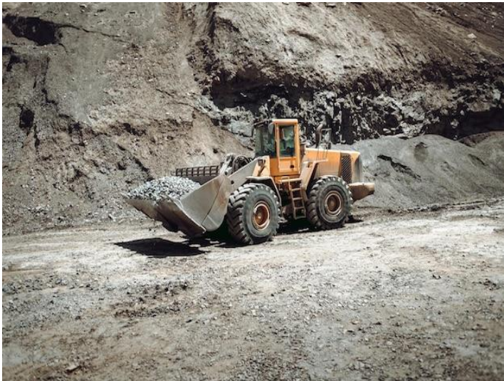
Figura 2-3 Extracción del árido con la maquinaria pesada.
