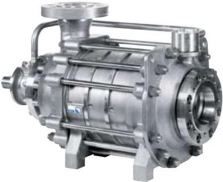
Figura 0-1. Bomba centrífuga de alta presión, multietapas de eje horizontal, seleccionada para el modo de bombeo de la central de pumped storage. Marca KSB, modelo HGM-RO [51].
