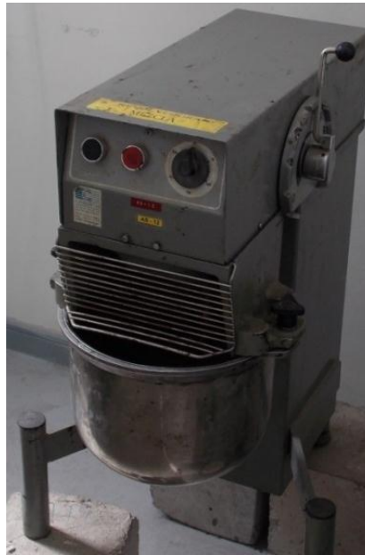
Figura 5-8: Mezcladora 600 watt propiedad de LEMCO USM. Fuente: Elaboración propia.
