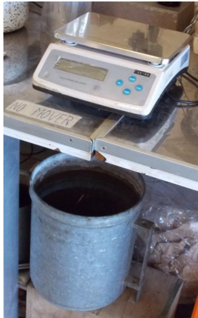
Figura 5-15: Equipo para medición de densidades de las probetas de mezcla asfáltica. Fuente: Elaboración propia.
