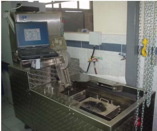
Figura 5-18: Rueda de Carga de Hamburgo. (HWTD) perteneciente a la empresa Asfalchile. Fuente: Elaboración propia.
