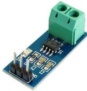
Figura 3.6: Sensor de corriente ACS712
