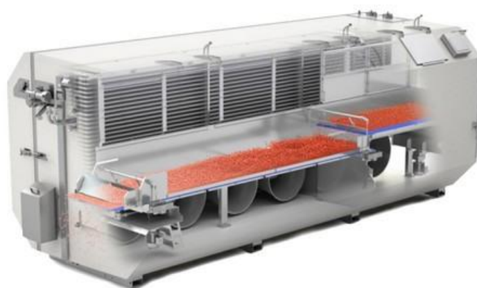
Figura 7. Túnel Individual Quick Freezing o congelado ultrarrápido (Fresh Plaza, 2019).
