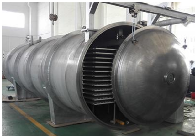
Figura 8. Liofilizador Industrial (BoLaiKe, 2026).
