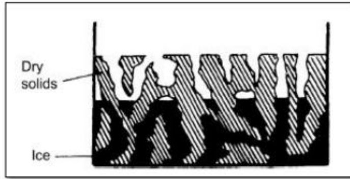
Figura 5. Material poroso generado durante la liofilización de alimentos (Ramirez, 2007).
