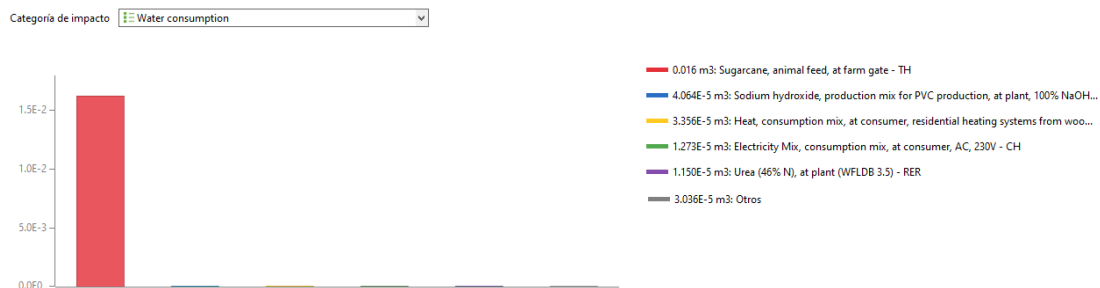
Figura 44. Gráfico de contribuciones directas, Consumo de agua, Envase (D). Extraído de OpenLCA.
