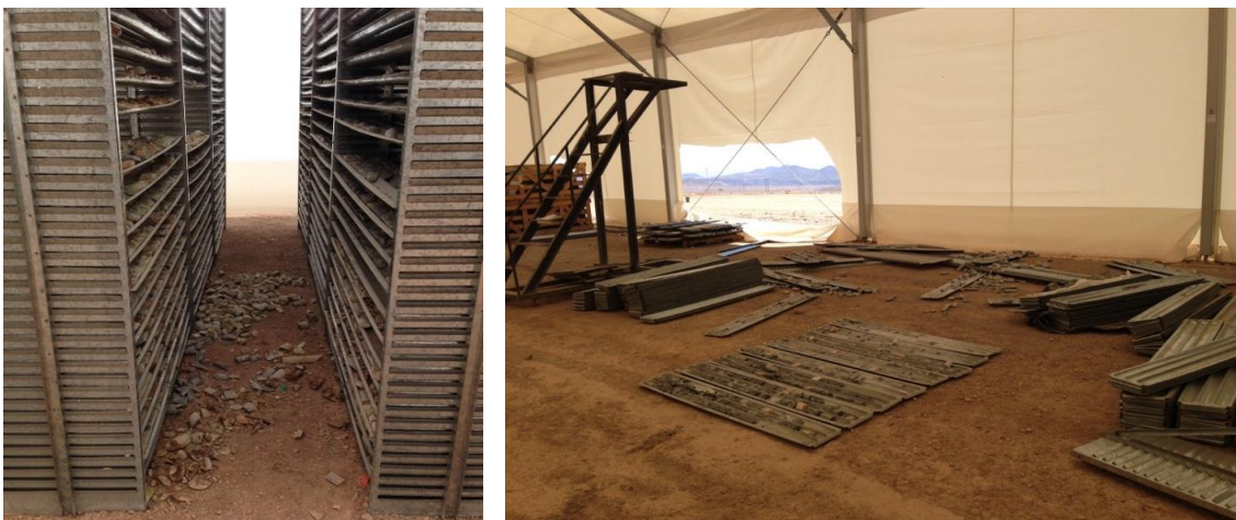
FOTOGRAFIA 3: Pérdida de muestras en bandejas de sondajes _Fuente: Testigoteca El Salvador, 2016.
