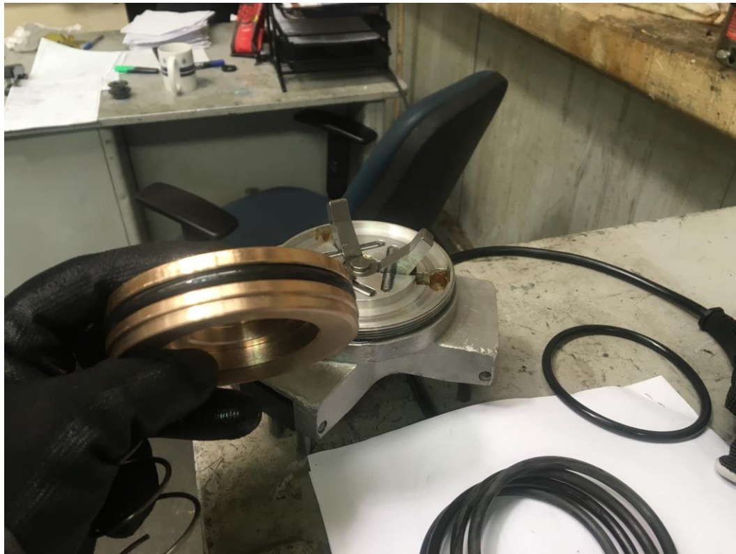
Figura 37: Pistola neumática en mal estado
