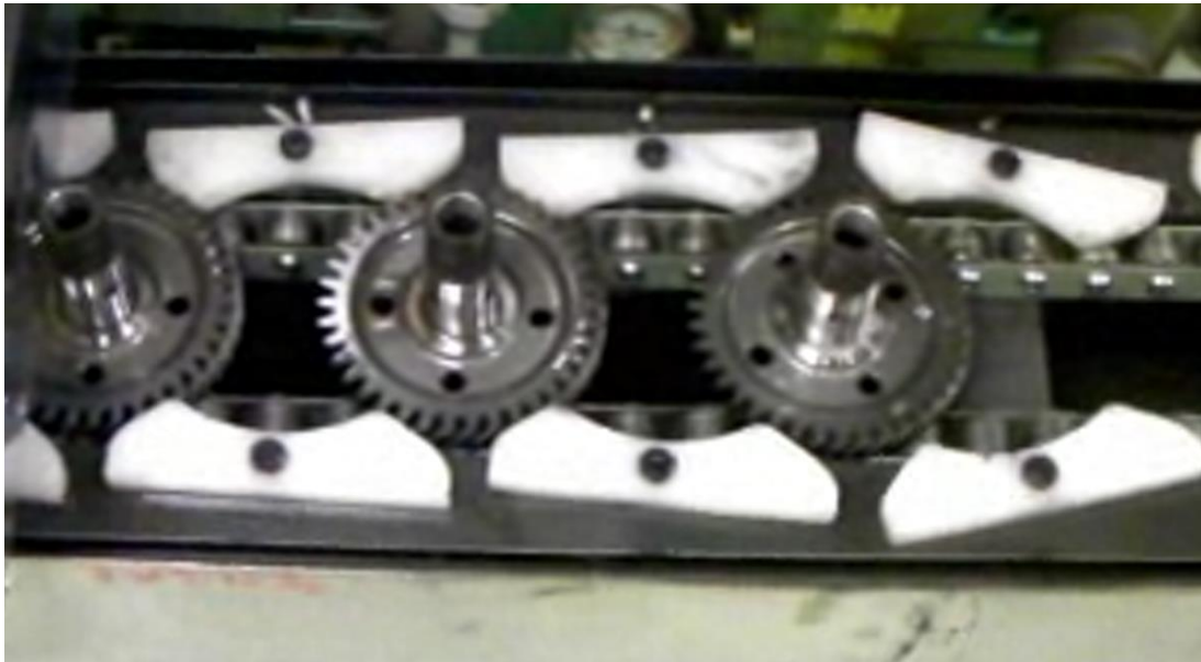
Figura 59: Ejemplo sistema actual Poka Yoke-Karakuri
