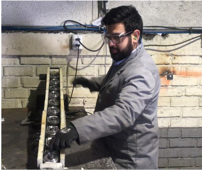
Figura 60: Prototipo Poka Yoke Karakuri
