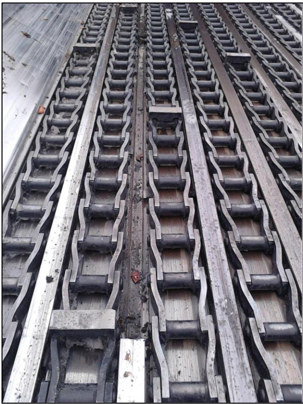
Figura 1-6. Vista extendida de las cadenas con zapata del sistema de alimentación Power Feed.
