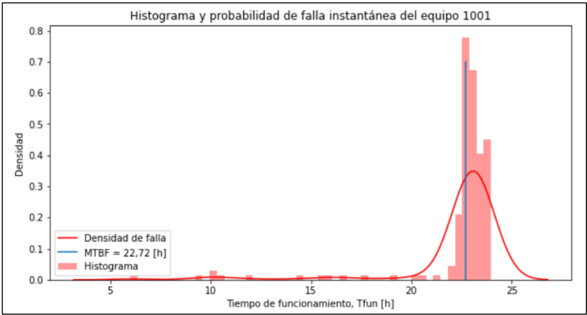
Figura 3-3. Histograma y densidad de la probabilidad de fallas del equipo 1001
