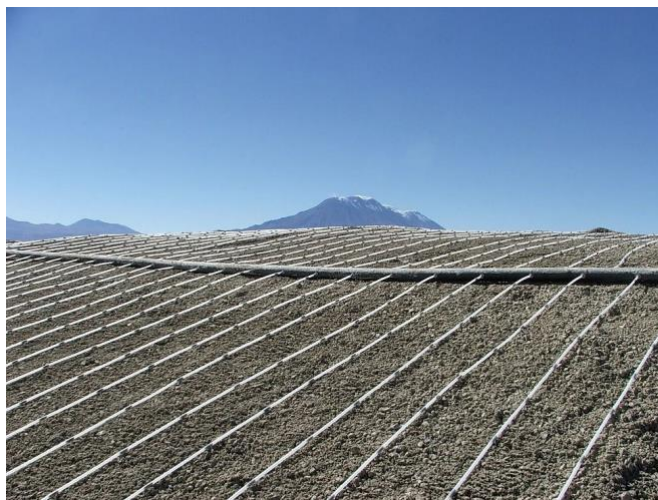
Figura 9: Sistema de riego sobre una pila de mineral. Fuente: BANFF S.A.
