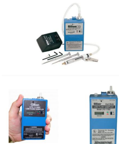
Figura 2.2. Bomba de muestreo marca Gillian modelo LFS-113D.
