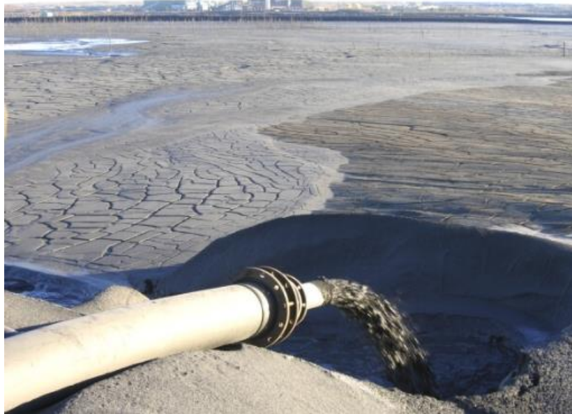
Figura 2–1: Descarga de relaves. Fuente: Portal Minería Chilena
