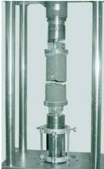
Figura 2.2: Muestra falla después de un ensayo de tracción (obtenido de internet).
