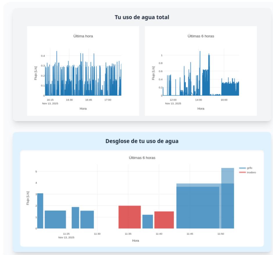
Fig. 3.30: Visualización del consumo total y desagregado por dispositivo en el dashboard de la plataforma, a partir de datos reales procesados por el módulo de desagregación.
