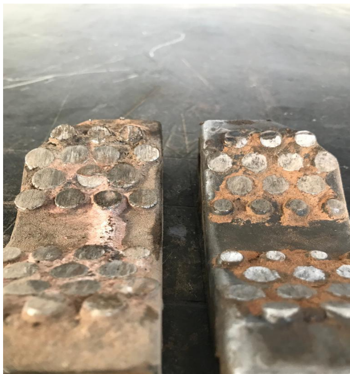
Figura 41 Mordazas desgastadas. Fuente: Elaboración propia.
