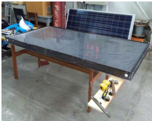
Figura 3.4: Radiador con pantalla de viento.
