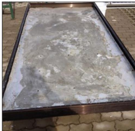
Figura 3.1: Estructura del radiador nocturno.
