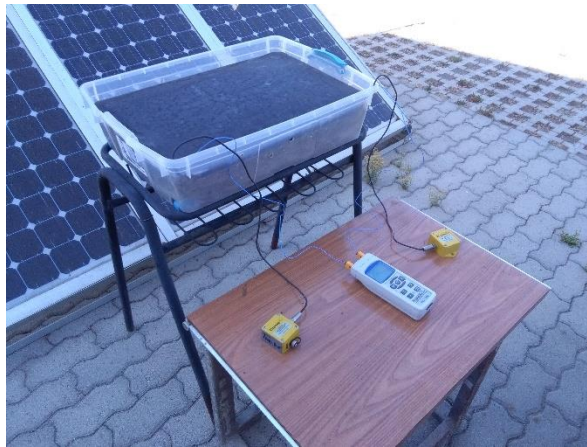
Figura 3.6: Calibración termocuplas con sensor PCE-T390.
