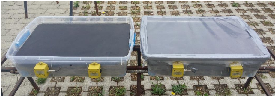
Figura 3.12: A la izquierda: radiador expuesto a la atmósfera. A la derecha: radiador con pantalla de viento.
