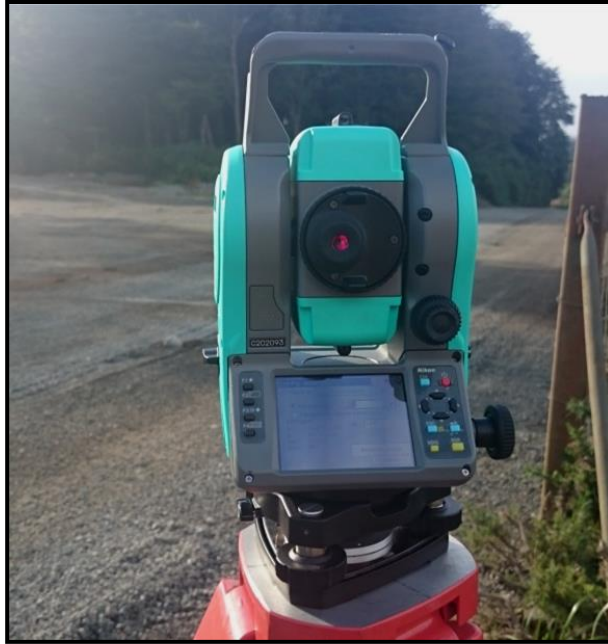
Figura 5-2 Modelo de Estación Total Nikon Nivo 5c [29]
