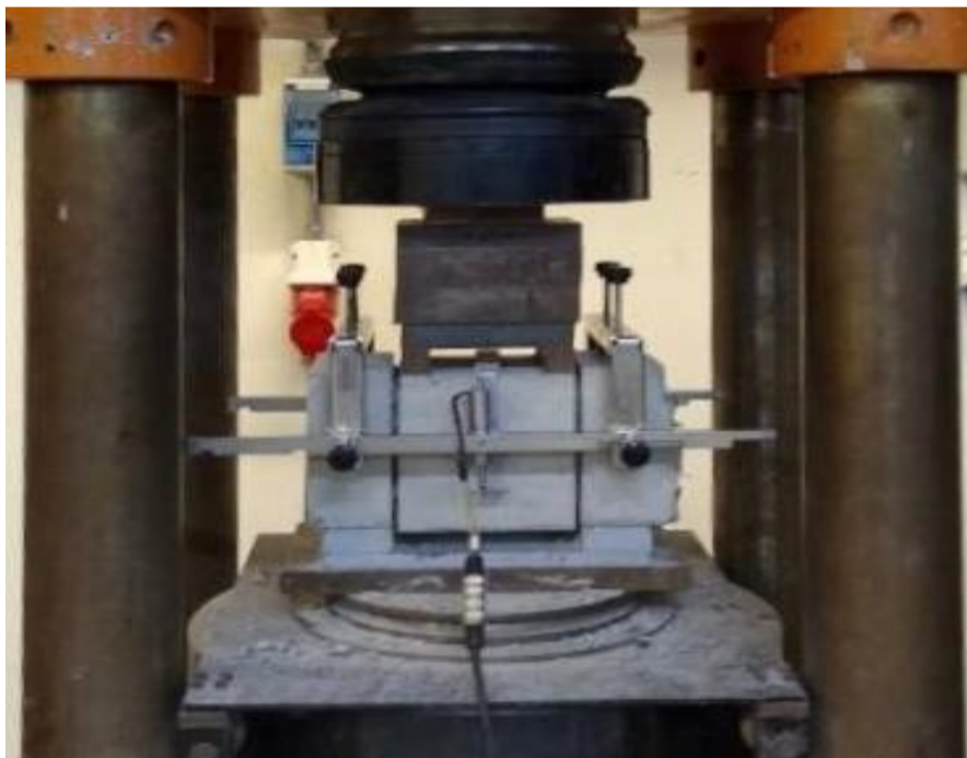
Imagen 5. Configuración lista para ensayo a corte.
