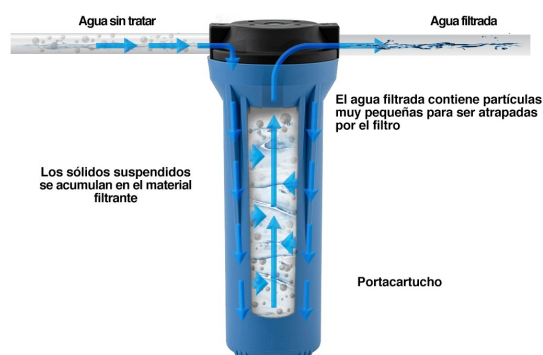
Figura 2-8. Funcionamiento filtro pulidor
