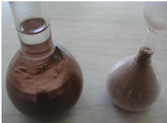
Figura 4.4: Ensayo de densidad al polvo captado.
