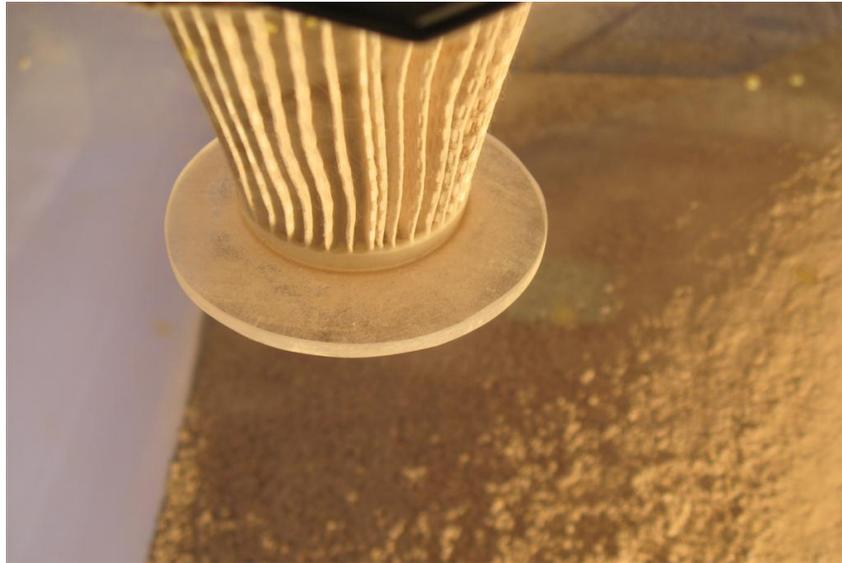
Figura 3.8: Filtro de Captación en operación durante un ensayo.
