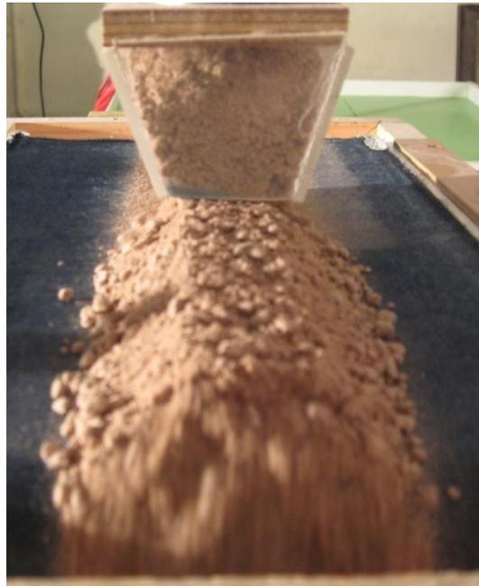
Figura 3.10: Alimentador de correa operando con mineral chancado de cobre.
