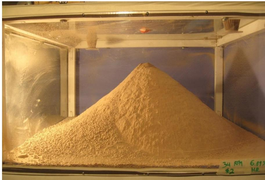
Figura 5.8: Segregación por trayectoria con mineral a 7[%] de humedad.
