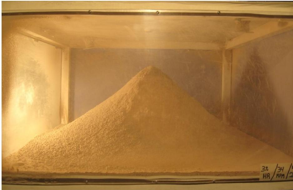
Figura 5.9: Segregación por trayectoria con mineral a 0[%] de humedad.
