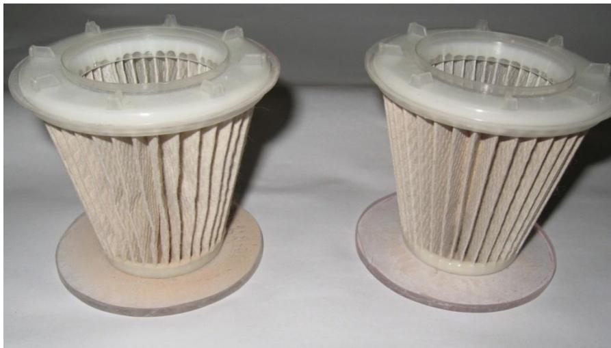
Figura 3.7: Filtros utilizados para la captación de polvo.
