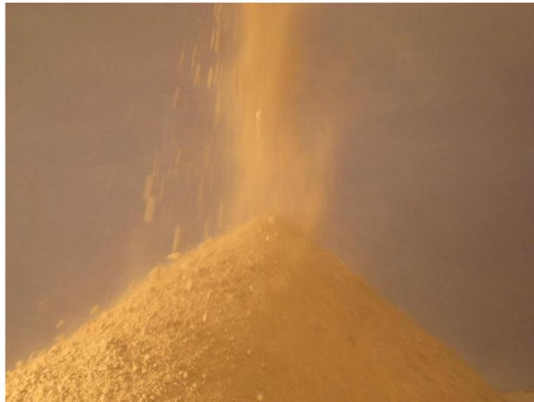
Figura 3.6: Separación de las partículas del flujo principal al llenar la pila.
