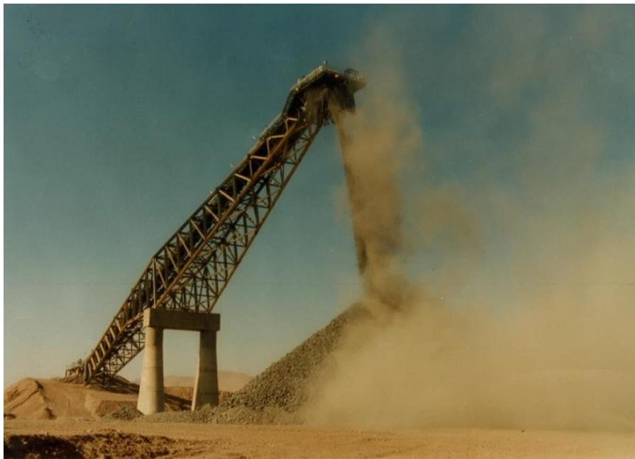
Figura 1.1: Generación de polvo en un stockpile cónico abierto, SCM Candelaria.
