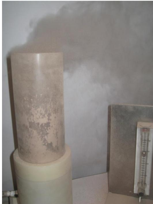
Figura 5.6: Ensayo de polvo captado con un “Dustmeter”.
