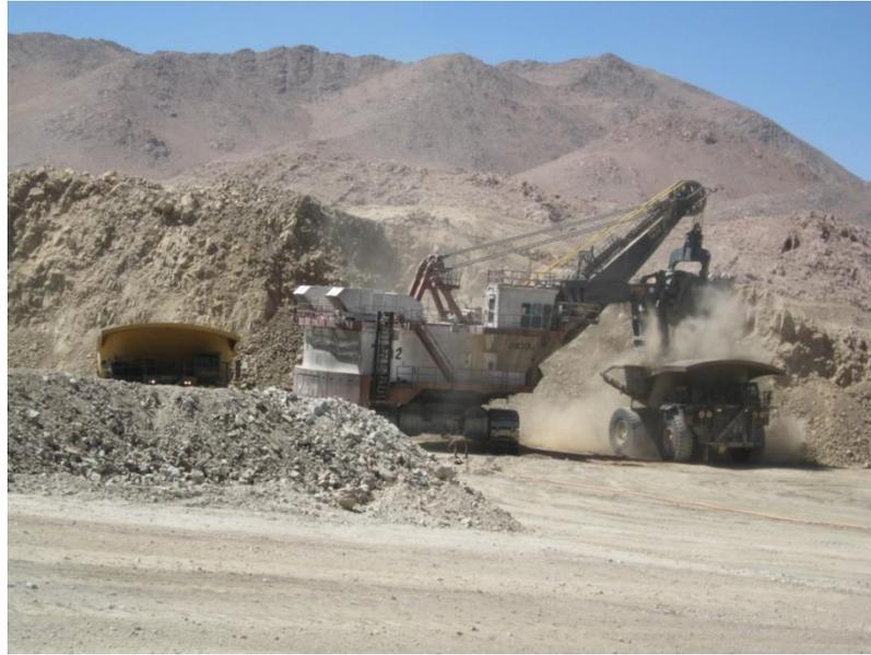
Figura 2.2: Generación de polvo durante el carguío de camiones en SCM Abra.
