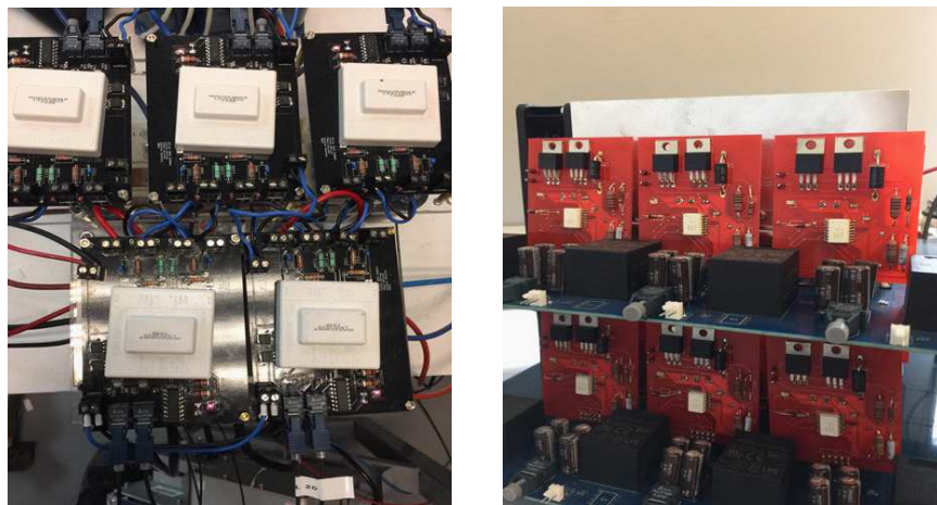
Figura 7.3: Drivers para convertidores (izquierda) dc/dc e inversor (derecha), que cuenta con desarrollo propio.
