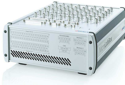
Figura 7.2: Equipo MicrolabBox en donde se procesan las señales para la implementación de los controladores.
