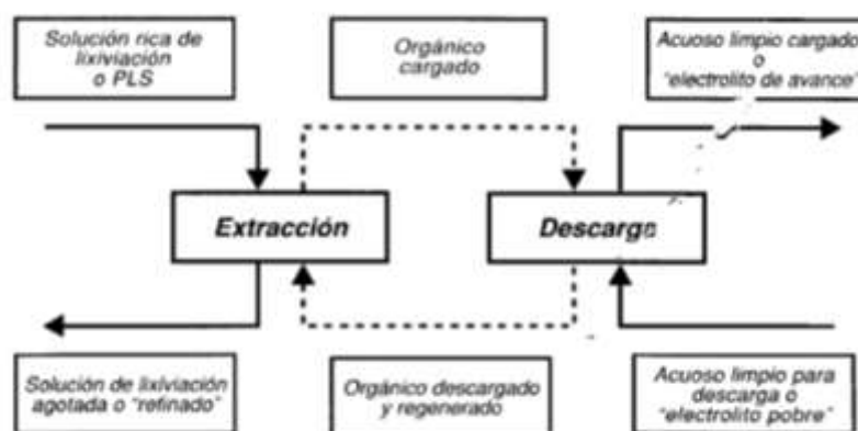
Figura 3.1 Partes esenciales del proceso de extracción por solventes. Fuente: (Domic, 2001)
