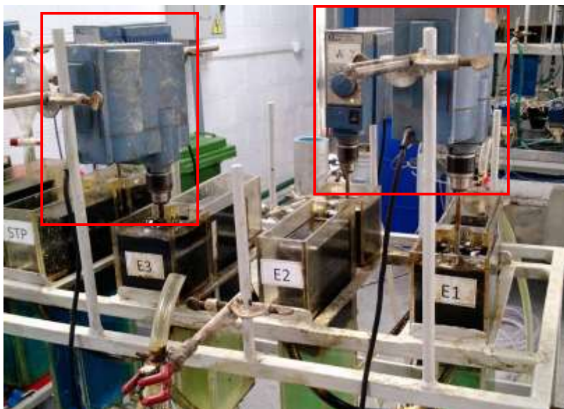
Figura 4.12. Planta piloto, Agitadores marca IKA, modelo RW16, potencia de suministro 55 W, rango de velocidad 40 – 1200 rpm.
