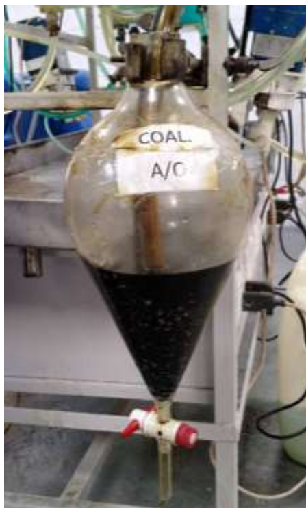
Figura 4.13. Embudo de decantación que cumple la función de TK de orgánico cargado.
