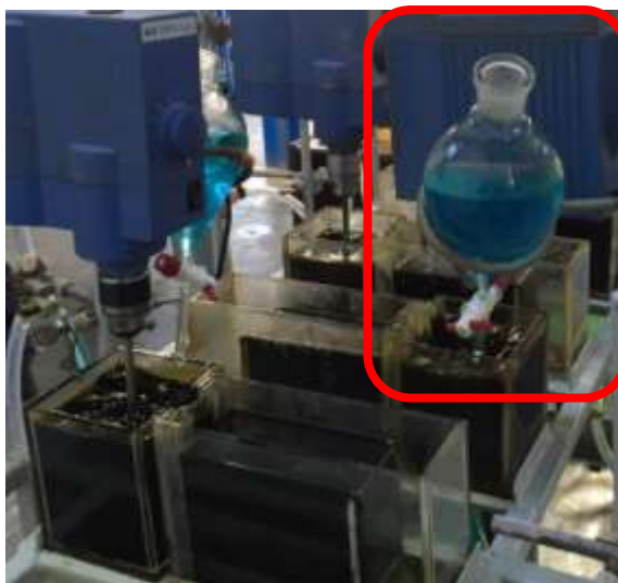
Figura 4.14. Embudo de decantación que alimenta de agua de lavado.
