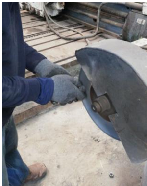
Figura 31: Preparación superficie cupón de análisis químico
