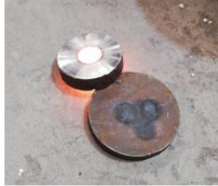
Figura 30: Cupón de análisis químico previamente a ser separado de la coquilla.
