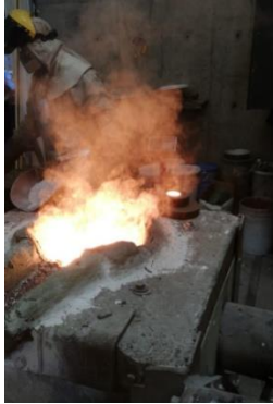
Figura 29: Cupón de análisis químico recién extraído del horno.
