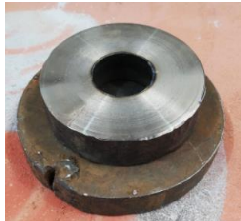
Figura 28: Coquilla en donde es solidificado el cupón de análisis químico.
