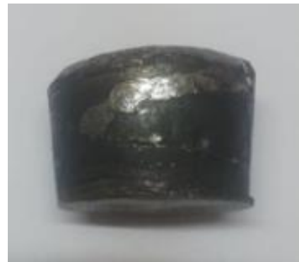
Figura 32: Cupón de prueba con superficie lisa previo a realizar análisis químico.
