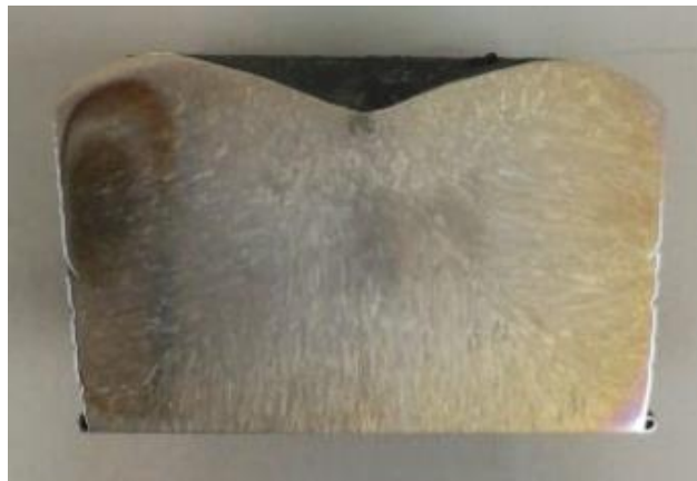
Figura 38: Cupón de prueba de acero dúplex post ataque químico.
