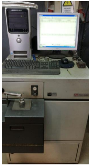
Figura 33: Espectrómetro de emisión óptica, Marca Bruker Elemental, Modelo Q6 Culumbus.
