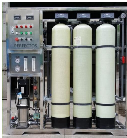
Ilustración 18. Sistema de Osmosis inversa
