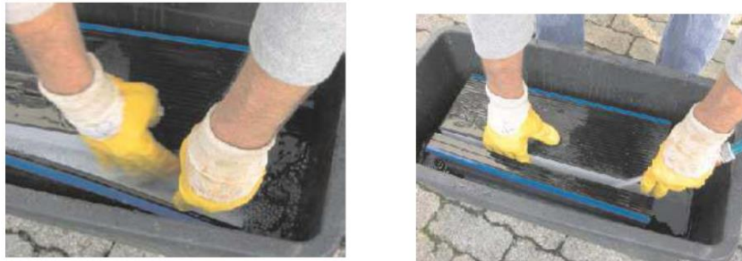
Imagen 8: Limpieza manual de membranas.
