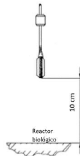
Imagen 6: esquema altura de boya.
